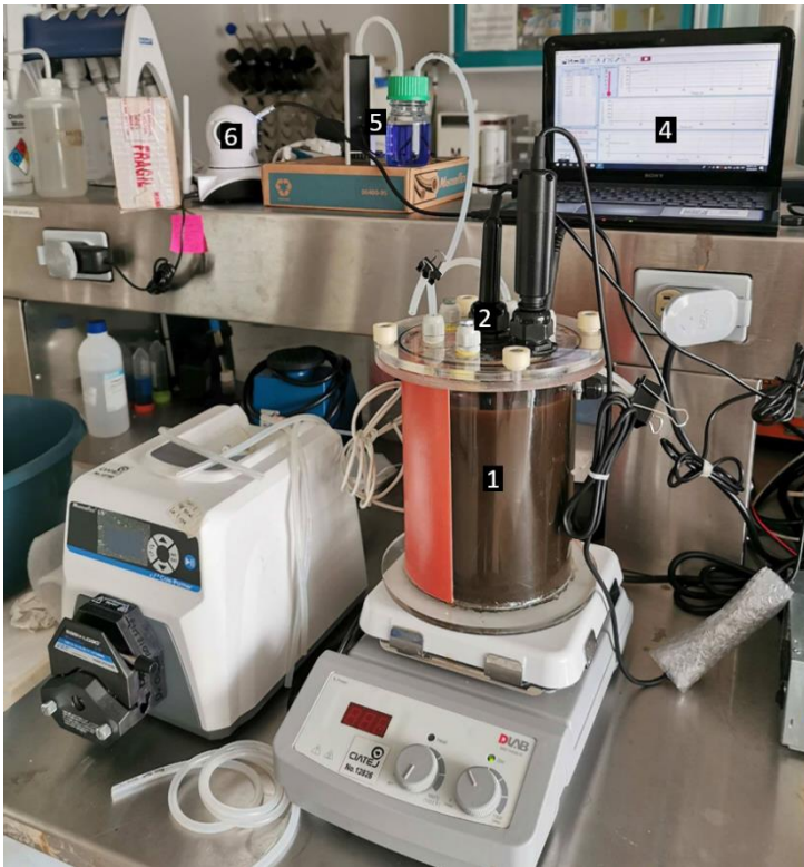
Figura 3. Sistema empleado para las fermentaciones en lote (ver texto para la especificación de los números).
