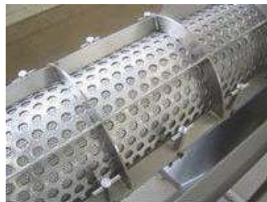
Fig. 4.8-2 Tambores de criba de los despulpadores: izq. Tipo recto, der. Tipo cónico
