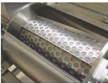
Fig. 4.8-2 Tambores de criba de los despulpadores: izq. Tipo recto, der. Tipo cónico
