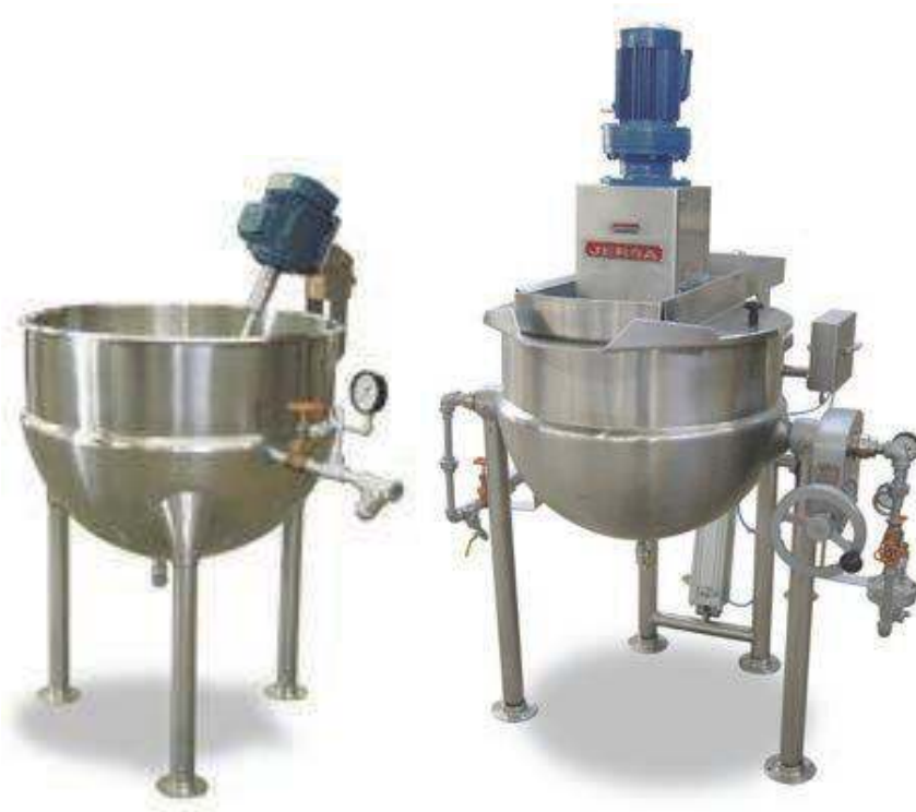
Fig. 4.9 Marmita con camisa de vapor y agitador: izq. Agitador de propela; der. Agitador de pared raspada
