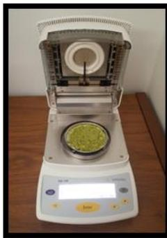
Ilustración 5. Termo Balanza
