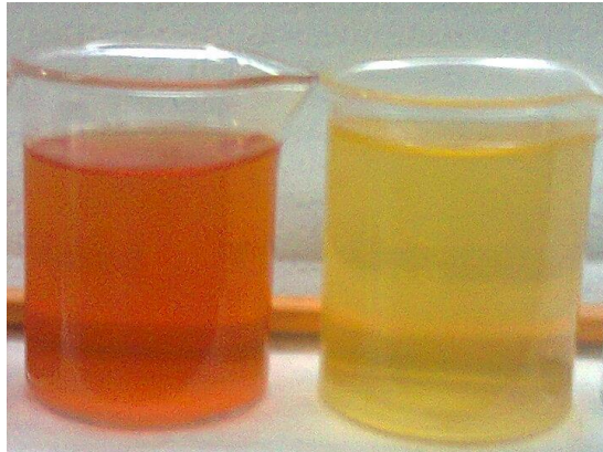
Figura 4.26 La apariencia de la calidad del agua después del tratamiento con DAF (izquierda) y salida del tratamiento de lodos activados (derecha)
