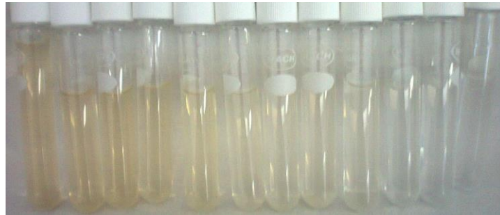
Figura 4.28 Remoción de color a diferentes dosis de a) Gráfica de remoción vs dosis de Hipoclorito de sodio añadido b) Apariencia del agua a diferentes dosis de NaClO.
