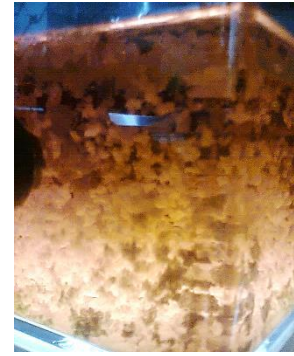
Figura 4.4 Prueba de jarras variando pH y b) Formación de flóculos a pH 7
