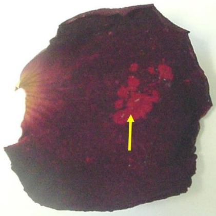
Figura 3. Pétalo de rosa deshidratado recuperando el color rojo después de agregar unas gotas de ácido clorhídrico 1N
