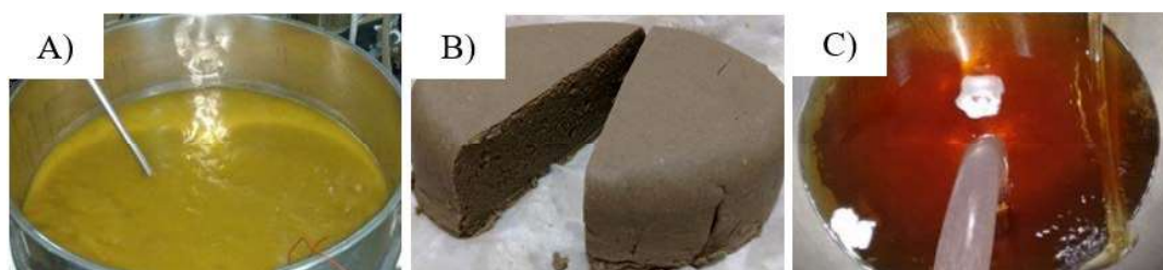
Figura 2. Fracciones de nejayote del proceso. A) Nejayote inicial, B) Pasta de nejayote, C) Rechazo de la membrana de 5kDa.
