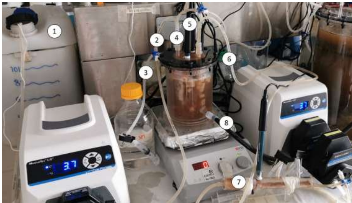
Figura 5. Fotografía del arreglo del reactor CSTR: 1. Contenedor de vinaza de alimentación, 2. Manguera de alimentación, 3. Manguera para la adición de álcali, 4. Conexión del espacio de cabeza del reactor hacia el \mu Flow®, 5. Sensores, 6. Manguera de salida, 7. Dispositivo cilíndrico para monitoreo del pH del efluente y 8. Conexión de chaqueta hidráulica
