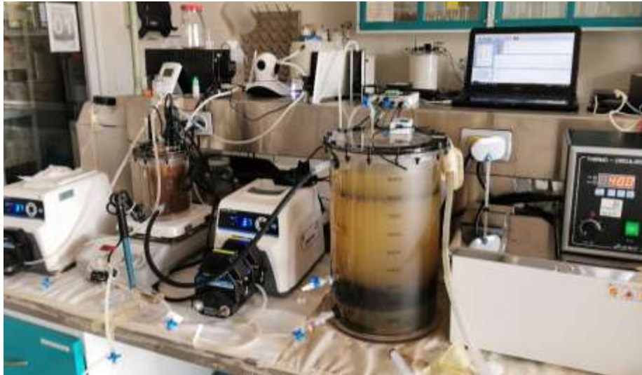
Figura 7. Fotografía del acoplamiento de reactores CSTR y UASB en el laboratorio
