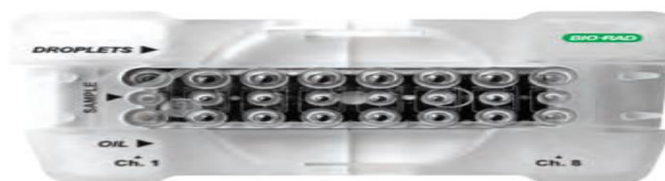
Figura 7. Cartucho especial para la formación de nano gotas, en este se deposita el mix de reacción y el aceite especial (Bio-Rad, s.f.-a).
