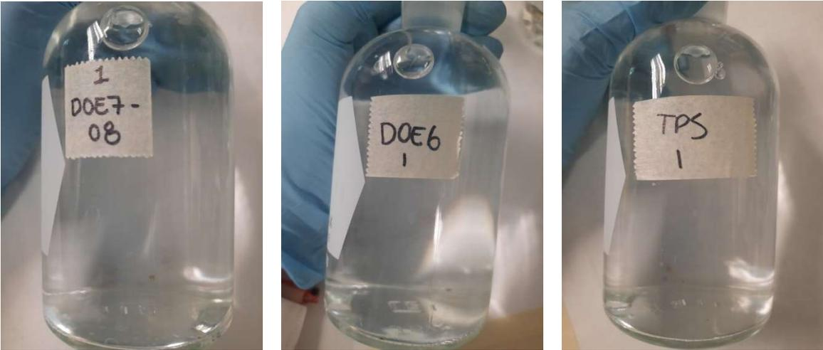
**Ilustración 5.** Pruebas de biodegradabilidad aerobia.
