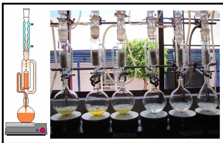
Figura 3-3 Obtención de extractos de limonoides mediante extracción soxhlet
