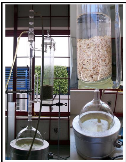
Figura 3-2 Remoción de aceite vegetal de semillas mediante hexano en extracción soxhlet
