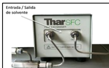
Figura 4-4 Intercambiador de Calor
